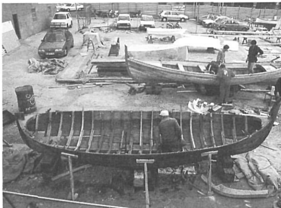
Procés de substitució del costellam malmès.
