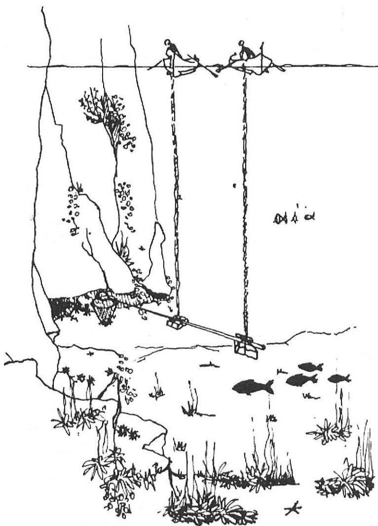
Artefacte per rascar el sostre de les coves, anomenat «busso» i manejat des de les embarcacions.
