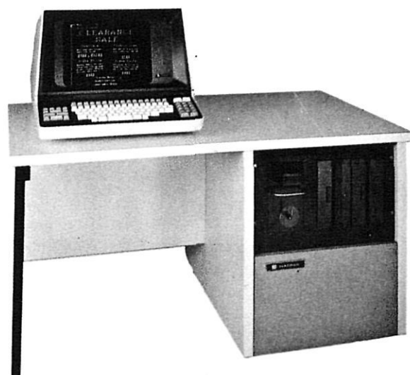
Un dels nombrosos models de fotocomposició actual, que ha representat un autèntic canvi de procediments en la impremta, entrant de ple a l'electrònica i els microordinadors. Podem observar-hi la «pantalla», el «teclat» i, a la part inferior, les unitats d'arxiu.
