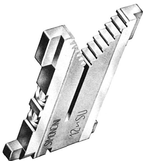
Peca fonamental de la màquina componedora anomenada «matriu». Hom pot observar-hi les dues parts bàsiques: el «dentat» i l'«ull» de la lletra.
