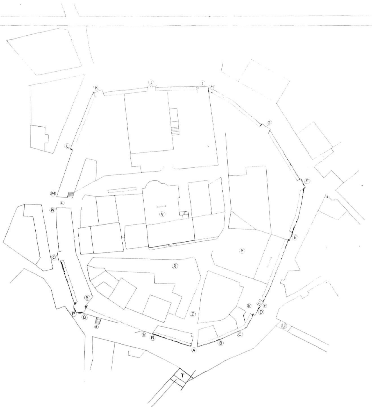
ULLASTRET - Plano de planta de la fortaleza medieval, en el que se advierte el recinto poligonal ochavado - de origen francés - adaptado a la topografía del terreno. En (A) único portal de entrada al fuerte, los demás accesos son posteriores; (P) torre cilíndrica, más antigua, puede pertenecer al siglo XII; las restantes, de planta cuadrangular, algo posteriores (siglos XIII - XIV). Iglesia parroquial románica, del siglo XI, en la cima de la acrópolis; (T) logia ojival a extramuros y (U) antiguo camino a La Bisbal, bajo arco. (Confeccionado por J. Sanz Roca, con datos del autor).
